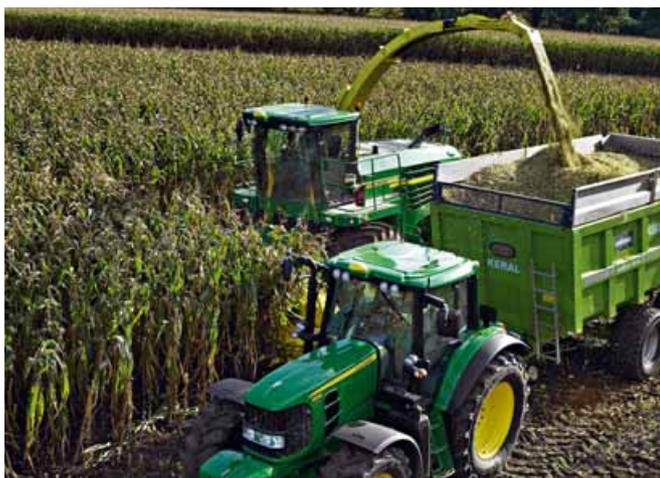
Le soluzioni "i" per le trincia John Deere garantiscono una lunghezza di taglio più appropriata in funzione della qualità rilevata dal sensore HarvestLab
