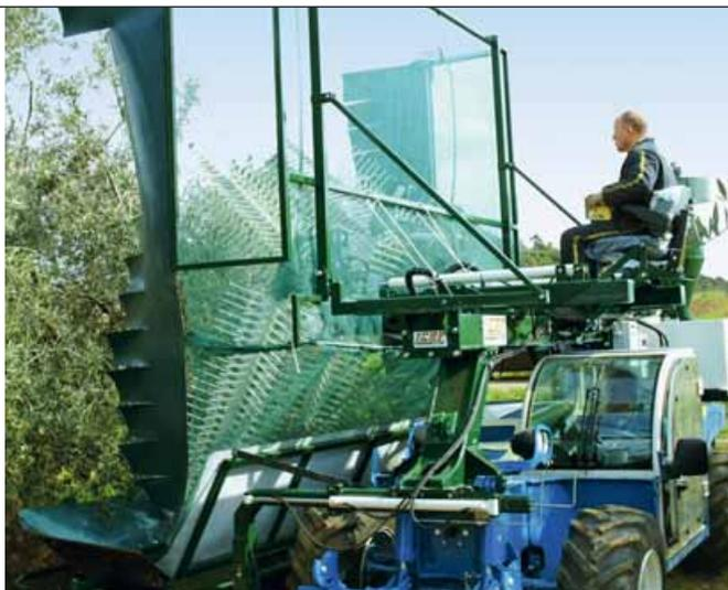
Mediante le due coppie di aspi bacchiatori, l'**Olive Two della Andreoli Engineering** permette la raccolta meccanizzata su impianti di ulivo convenzionali, intensivi e superintensivi
