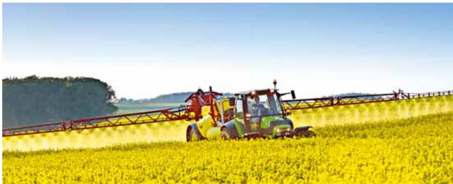
**Il motore Natural Power della Sdf, a bassi regimi o a temperature non idonee, viene alimentato a gasolio. Appena i parametri (temperatura e carico del motore) lo permettono l'alimentazione passa a olio di colza**
