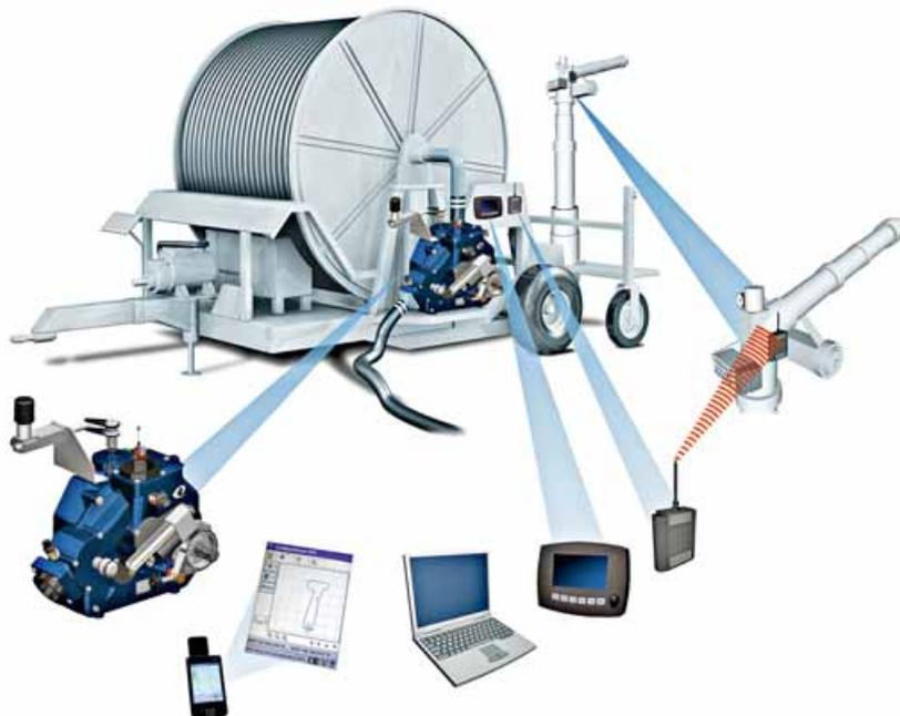
Il **sistema di controllo degli irrigatori a naspo** – proposto dalla collaborazione tra Comer Industries, Ocmis Irrigazione e Simi Idromeccanica – è costituito da un insieme di sensori, da una centralina di controllo e da attuatori che regolano la distribuzione dell'acqua
