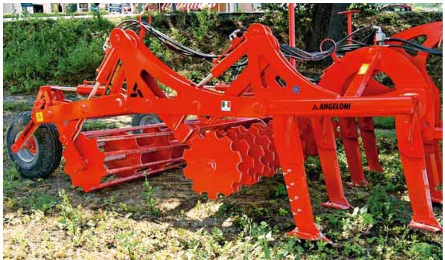
Il coltivatore della Angeloni ha la possibilità di variare la profondità di lavorazione dei propri utensili in funzione dello sforzo di trazione rilevato mediante opportuni sensori
