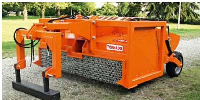
**Falc** propone una **trinciatrice verticale** per le piante di ananas. I due rotori evitano di compattare il terreno, inconveniente riscontrato con le trinciatrici a rotore orizzontale
