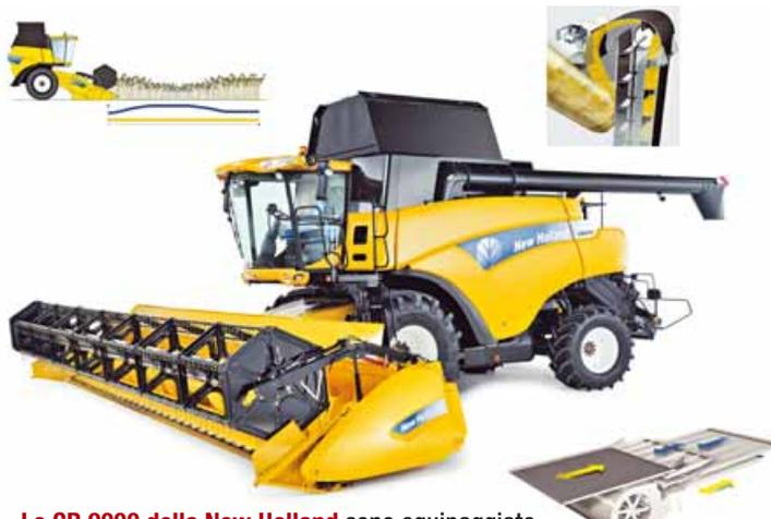
Le **CR 9000 della New Holland** sono equipaggiate con sistema di pulizia Opticlean (in basso a destra), di controllo della portata IntelliCruise (in alto a sinistra) e di rilevazione della qualità della granella (in alto a destra)
