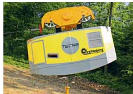
Il carrello semovente per gru della Greifenberg permette di ridurre la manodopera richiesta essendo comandato via radio
