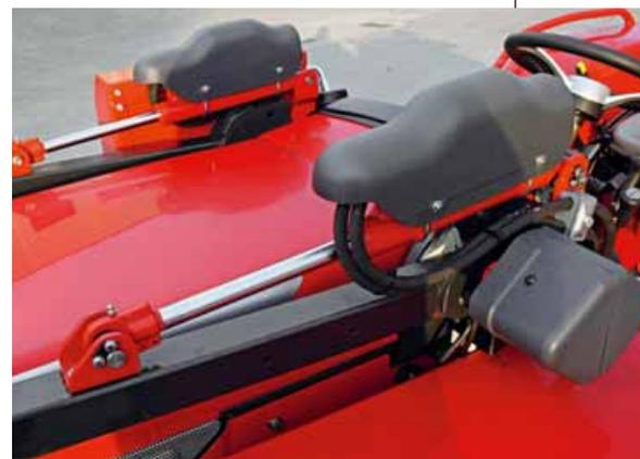
Azionato manualmente o tramite l'inclinometro, la **centralina elettroidraulica della D'Eusanio** comanda l'innalzamento del Rops
