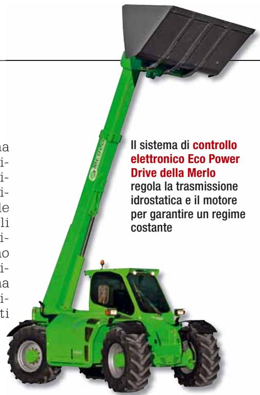
Il sistema di **controllo elettronico Eco Power Drive della Merlo** regola la trasmissione idrostatica e il motore per garantire un regime costante
