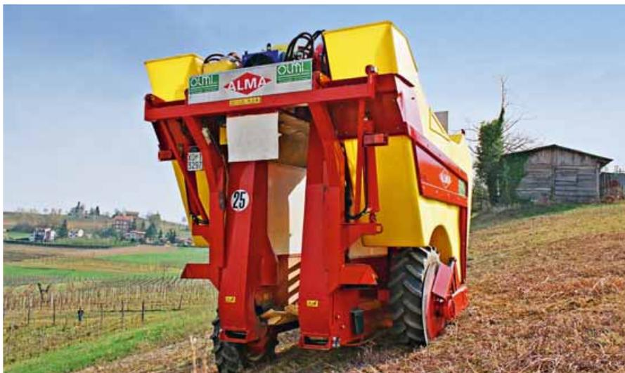
Olmi con il **sistema S.T.E. antiderapata** garantisce il mantenimento della traiettoria sui filari del vigneto evitando alle ruote di scivolare su terreni a elevate pendenze
