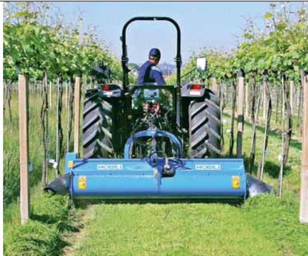
La **trinciatrice della Nobili** invia il materiale triturato dell'interfila in corrispondenza dei filari di vigneti e frutteti, effettuando una pacciamatura di materiale organico, utile per il controllo delle piante infestanti
