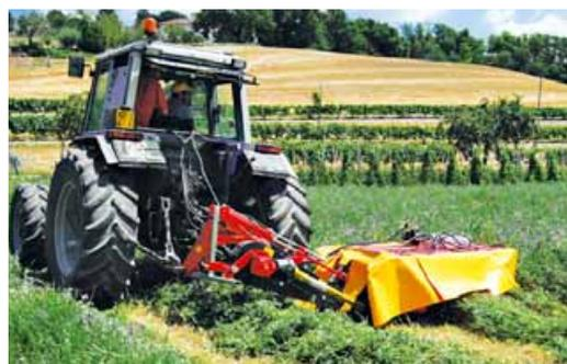
**Falciatrice della Agriwork, che modula l'intensità del condizionatore idraulicamente, come pure l'altezza di taglio**
