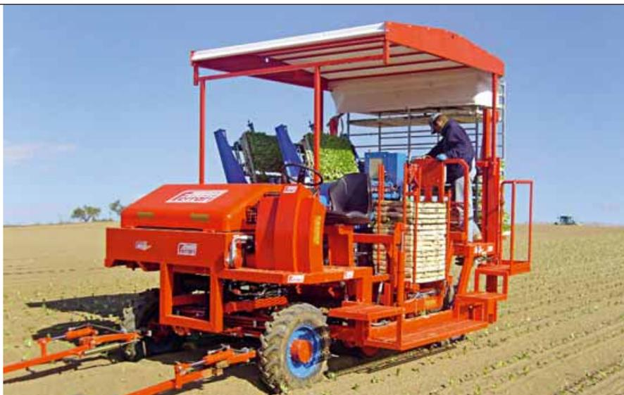
La **trapiantatrice della Ferrari** varia mediante un computer la distanza di trapianto sulla fila delle piantine in contenitori alveolati
