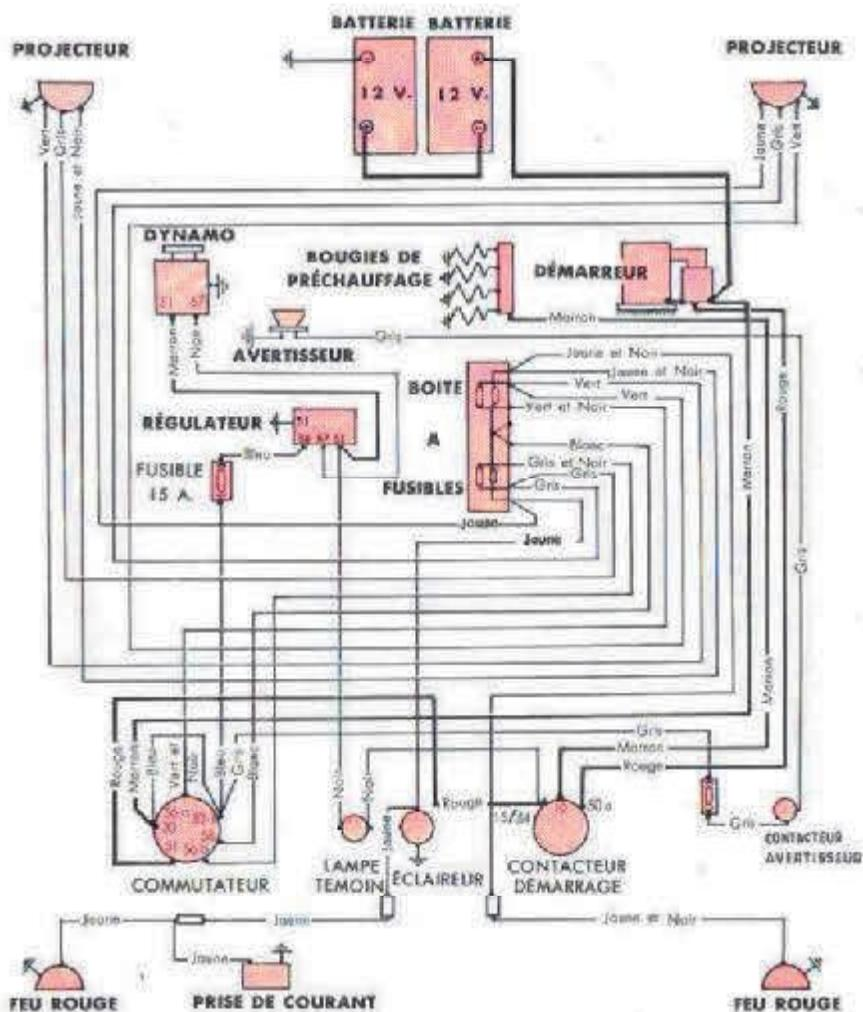
FIG. 38 — Schéma de câblage électrique.
