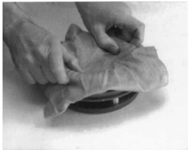
2. Posizionare l'anello sincronizzatore della gamma LO più grande sul banco ed estrarre il sincronizzatore della gamma HI dai perni di blocco. prima di farlo, coprire il gruppo con un panno per evitare di perdere le tre molle rilasciate dalle posizioni dei perni del sincronizzatore della gamma HI.
