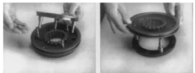
3. Individuare le tre molle del sincronizzatore e rimuovere l'anello del sincronizzatore della gamma HI (a destra) rimuovere la frizione scorrevole dal sincronizzatore della gamma LO.
