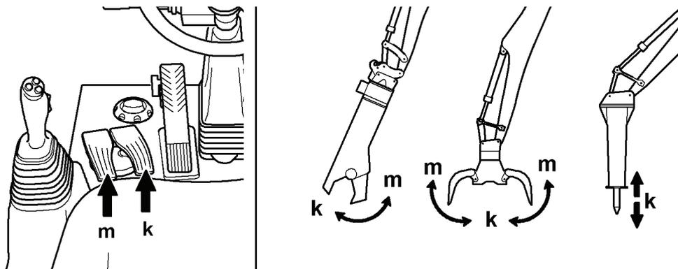
Fig. 3-77 Azionamento dell'utensile di lavoro
