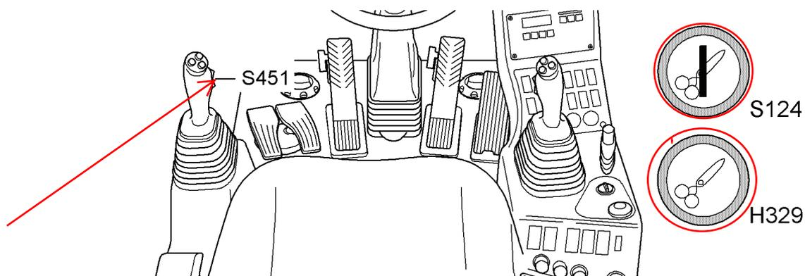
Fig. 3-79 Elemento di comando funzionamento continuo
