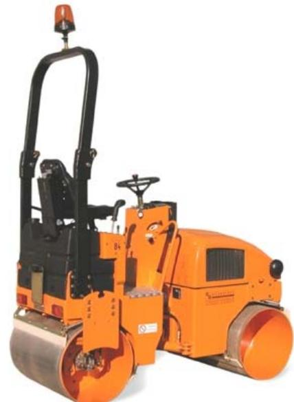
**Epv 101 S – 151 S – 201 S**: Gamma di rulli vibranti con telaio articolato, doppia trazione idrostatica in serie e vibrazione oleodinamica. **"Filo muro"** anteriore per la compattazione in presenza di manufatti. Motori diesel raffreddati a liquido con avv.el da 9Hp e 21HP-Peso 1000 -1500-2000 Kgs
