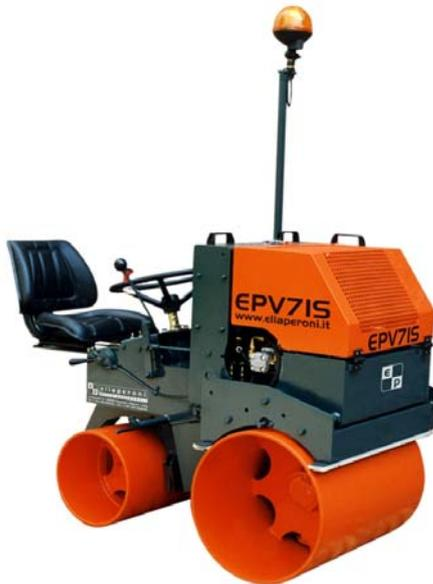
**Epv 71 S**: Minirullo ideale per piccoli lavori stradali, manutenzioni urbane e di impianti sportivi, particolarmente adatto alle esigenze delle pubbliche amministrazioni. Trazione e vibrazione oleodinamica. **"Filo muro"** anteriore . Motore diesel con avv.el da 9Hp -Peso 750 kgs. Disponibile anche in **versione M** con guida manuale a timone
