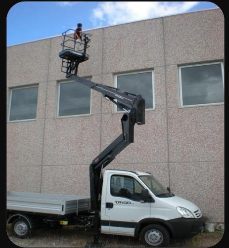
La specifica d'uso del TRIGO ha reso possibile la disposizione degli stabilizzatori all'interno della sagoma, eliminando l'apertura d'ingombranti zampe d'appoggio e riducendo i tempi di piazzamento. Questa semplicità d'uso facilita il lavoro evitando transennamenti ed intralci alla normale circolazione.
