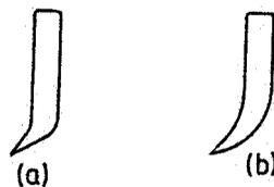
Le punte si possono suddividere in corte, medie, lunghe. Il tipo corto serve dove la penetrazione è difficile e l'impatto può essere forte; il tipo lungo per impieghi in materiali molto abrasivi, ove la possibilità di rottura non è il problema principale. Il tipo intermedio è raccomandato per applicazioni in cui il materiale abrasivo è duro abbastanza da rompere la punta lunga.
