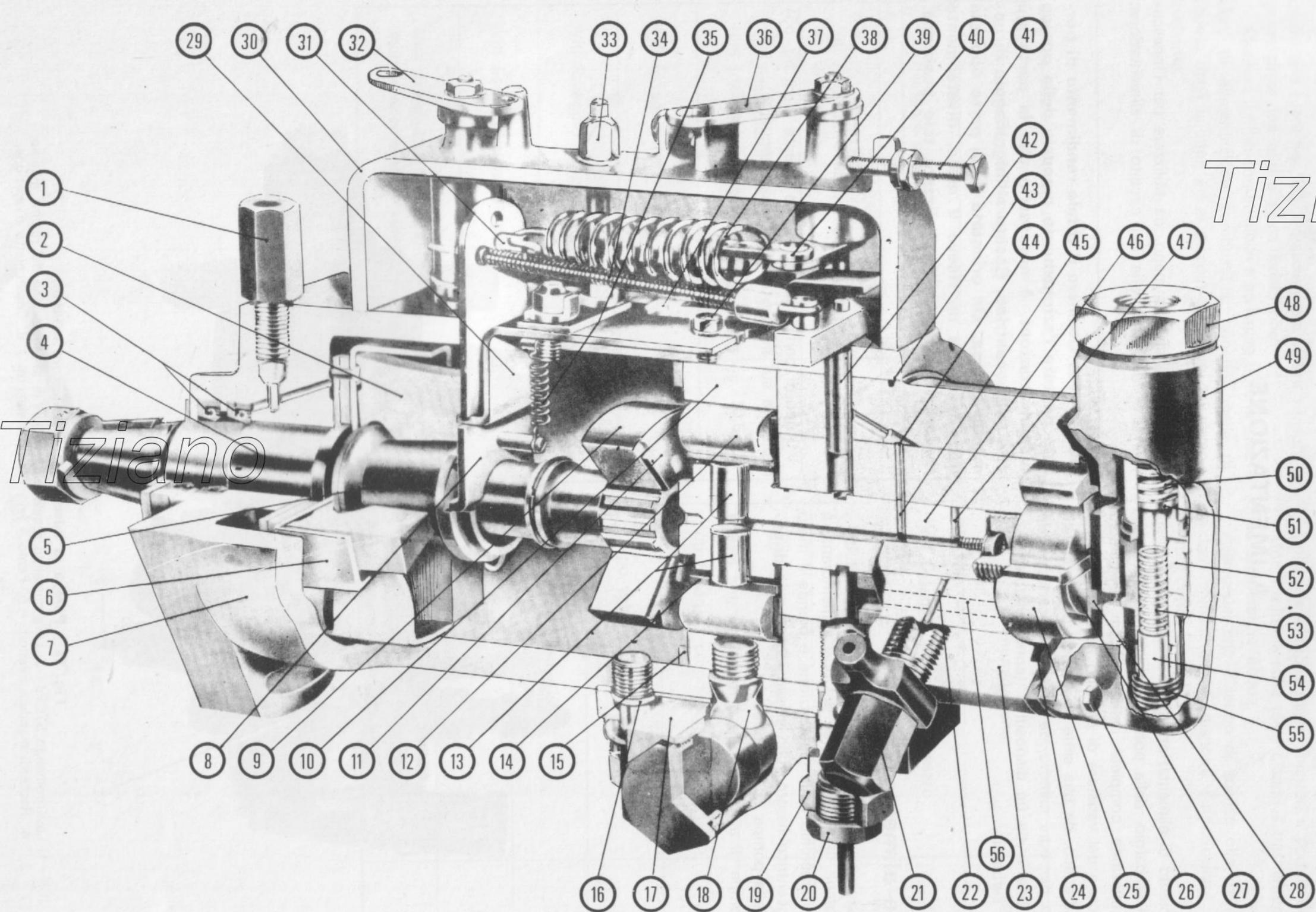
Fig. 56 - Sezione pompa iniezione.
