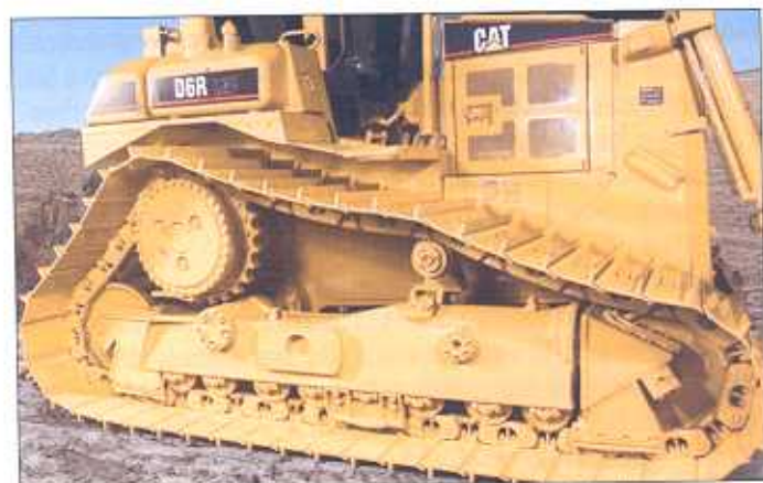
Il cingolo del D6R con la caratteristica ruota motrice rialzata
