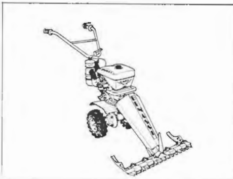
Fig. 19 - Trasformazione in falciatrice - Umbau in Mähmaschine - Transformación en máquina segadora
