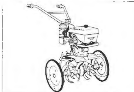
Fig. 23 - Ruote laterali per il trasferimento - Seitliche Laufräder - Ruedas laterales para el traslado
