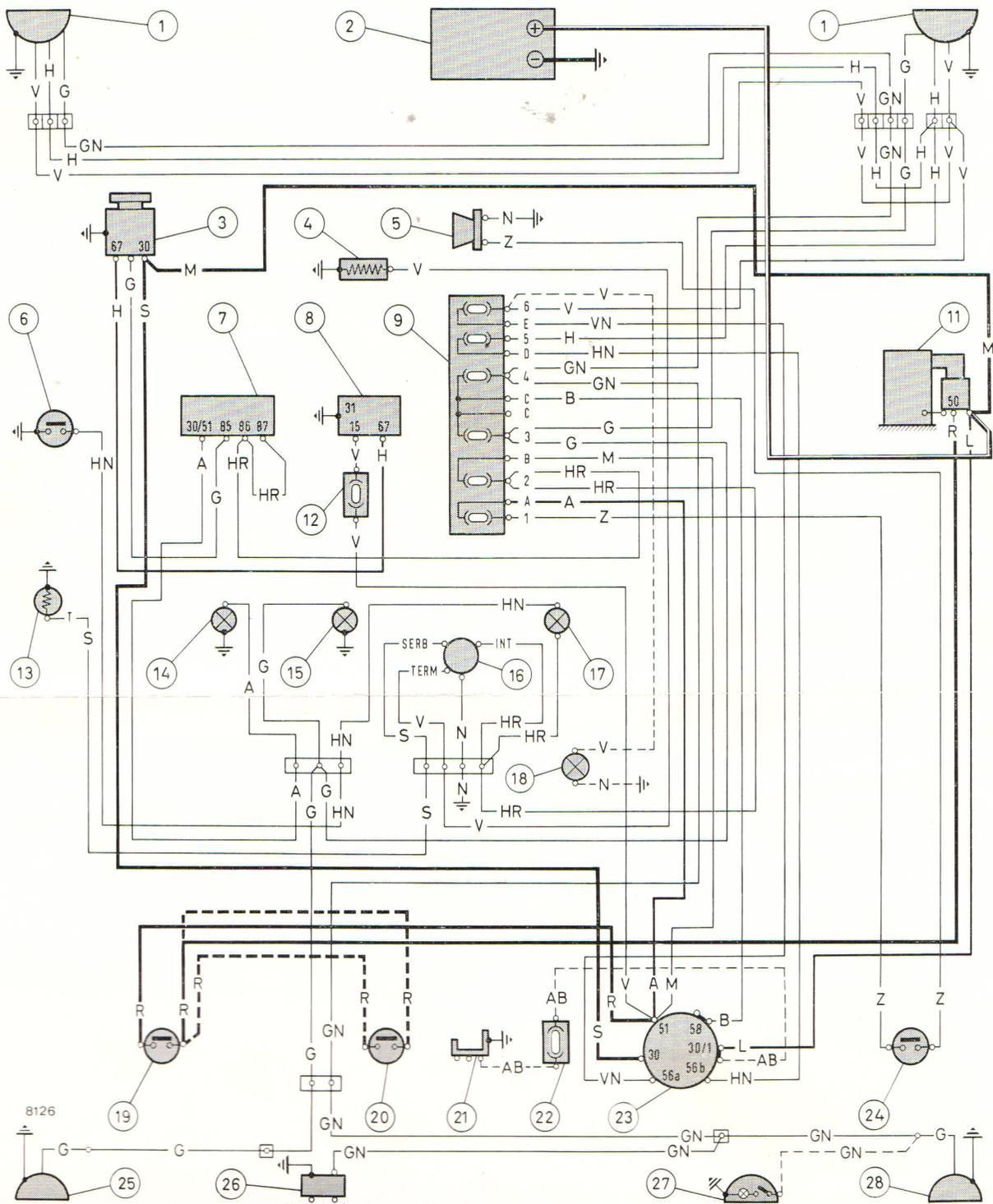
Fig. 20. - Schema dell'impianto elettrico (tensione 12 V).
