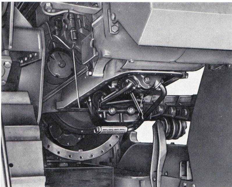
**Fig. 41 - Smontaggio della coppa a motore montato sul trattore.**
